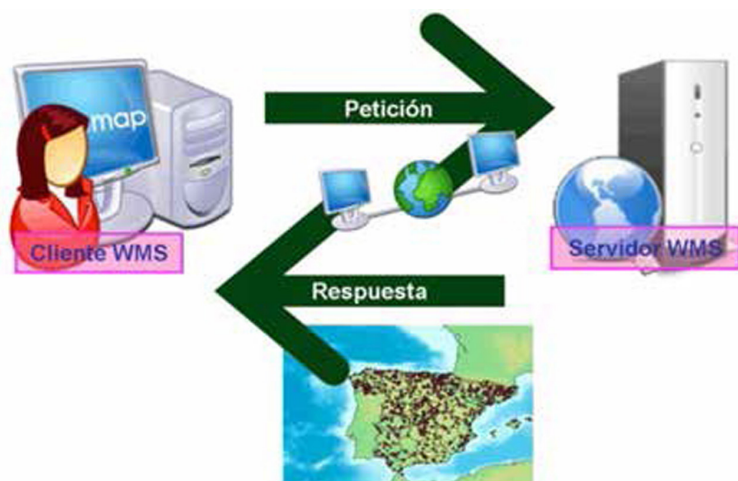
Fig. 1. Esquema Cliente – Servidor WMS (Iniesto y Núñez 2014, 185).
