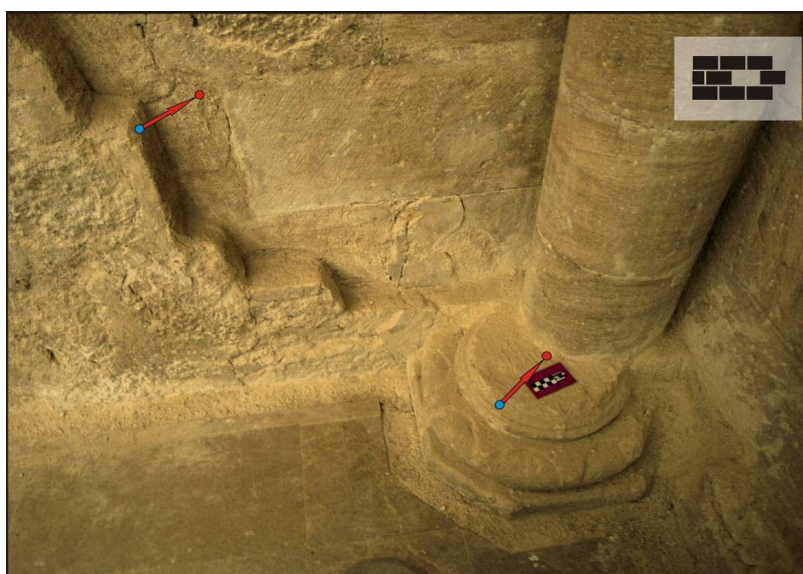
Figura 11. Vector de desplazamiento de la esquina NO de la Torre del Espolón en el Castillo de Lorca, como consecuencia del terremoto de Lorca del 11 de mayo de 2011.
