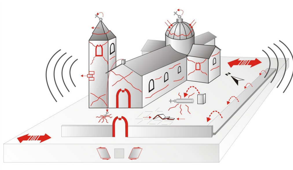
Figura 12. Construcción idealizada con los Efectos Arquitectónicos de Terremotos (EAEs) teóricos que generaría un movimiento sísmico con un desplazamiento del sustrato en dirección NO-SE.
